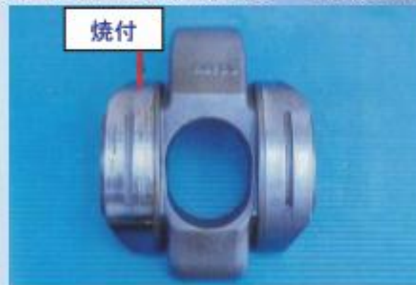
斜盘支撑台(倾斜机构部)的发热胶着
